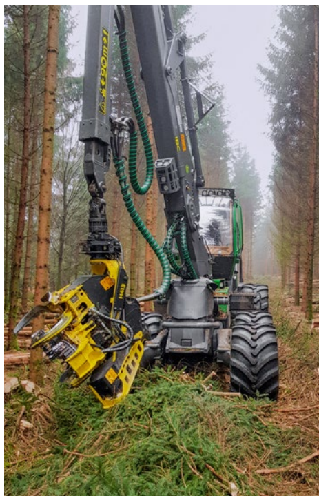
Abb 2 Geplante Rückegassen und Befahrungskonzepte erleichtern die Arbeit und reduzieren Bodensowie Bestandesschäden. Hier: Harvester mit Mehrbaumsammler-Aggregat.
